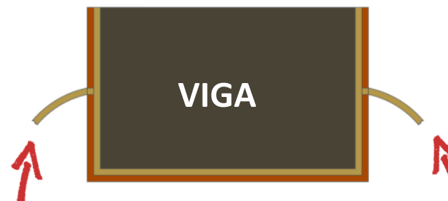
Encamisado metálica e inyección de resina
